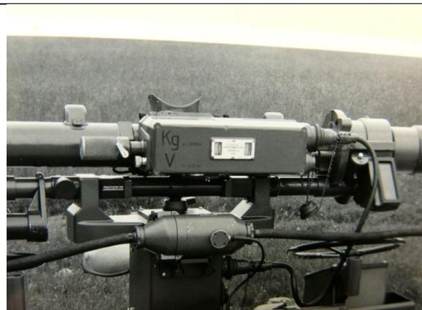
>> ... Zum KdoGt, zum Verograph, sowie Steckdose zum „Trockenapparat 80 V“. Ablesung am HL-Getriebe an zwei Skalen: Schrägdistanz und Höhe (bei Bedarf, wird elektrisch weitergeleitet).
