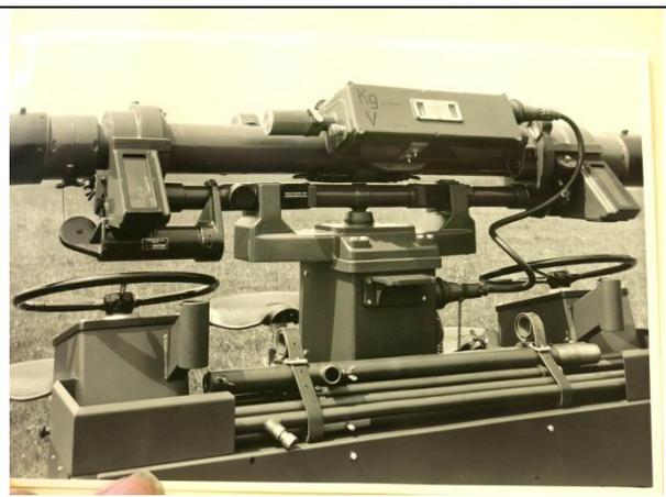
Der Ausblick für Seiten- und Lagewinkel geht fix unter dem Rohr durch, wird durch die Rohrdrehung nicht tangiert. Ausblicksöffnung durch die schrägen Fenster ist sehr ähnlich wie beim Zeiss-Auswanderungsmesser 1917 (!)
