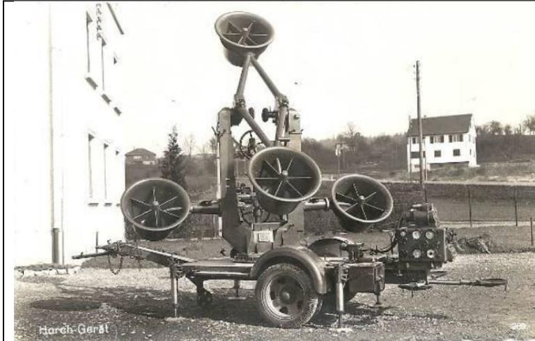
Versuche wurden in der Schweiz 1937 mit dem tschechischen Horchgerät TEPAS gemacht – rechts der Rechner. Die Ergebnisse waren gut, aber die Zerlegung und der präzise Wiederaufbau kompliziert – das ELASCOP musste nicht zerlegt werden.
