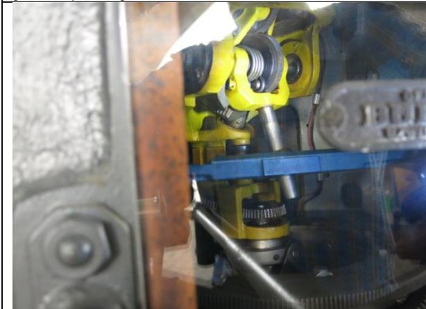
Am Horchgerät wird nichts verändert, aber am Handrad ein anderer Flugzeugkurs eingestellt. Der gelbe Topf kreist, die Achse des gelben U verdreht sich gegen die horizontale Drehachse des blauen...
