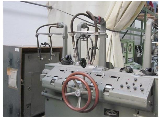
Wahrscheinlich der Platz des Instruktors, der als einziger zwei Handräder hat. Alle Bewegungen werden auf Papierstreifen protokolliert. Links hinten ist die Schallquelle mit zwei Plattenspielern, Röhrenverstärkern, Tongenerator mit oder ohne Oberwellen, und mit zuschaltbaren Störmöglichkeiten. Rechts elektr. Kopfhörer: ev. spätere Versuche ?
