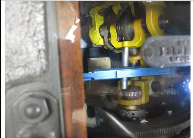
... Bügels. Ort und Drehwinkel des Schieberohres aussen haben sich verändert, der korrigierte Höhenwinkel ebenfalls (Steilheit des blanken Stössels durch das Kugelgelenk). – Reflexe am Glas.
