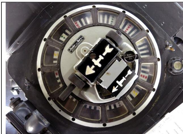
Blick von oben auf die drehbare Fensterscheibe mit dem Pfeil des absoluten Flugzeugkurses, darunter die „Bunte Scheibe“. Sie ist **exzentrisch** montiert und dreht sich um ihr Zentrum, entsprechend der Neigung der Horchdachebene. Das Zentrum seinerseits wandert um die Symmetrieachse der Fensterscheibe, je nach Azimut des Horchgerätes und je nach Bewegung des Handrades. Durchmesser der Fensterscheibe: 35 cm. Maximale Horizontalverschiebung der bunten Scheibe: 4 cm
