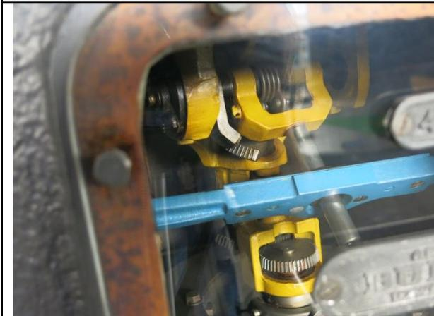
Die Neigung des gelben U wird über ein Schrägachs-Zahnrad nach unten zum Rad des inneren Schieberohres geführt, das Azimut des gelben Topfes (liegt höher oben, siehe 2 letzte Bilder) wird unten ...
