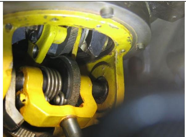
Blickrichtung nach oben: Bei sehr hohem oder sehr tiefem blauen Bügel werden oben neue Elemente sichtbar: Zahnrad zum Antrieb der bunten Scheibe (links) resp. die „Lyre“, ein schräg stehender dunkler Grosskreis am Himmel (Bild rechts), dessen Neigung mit...
