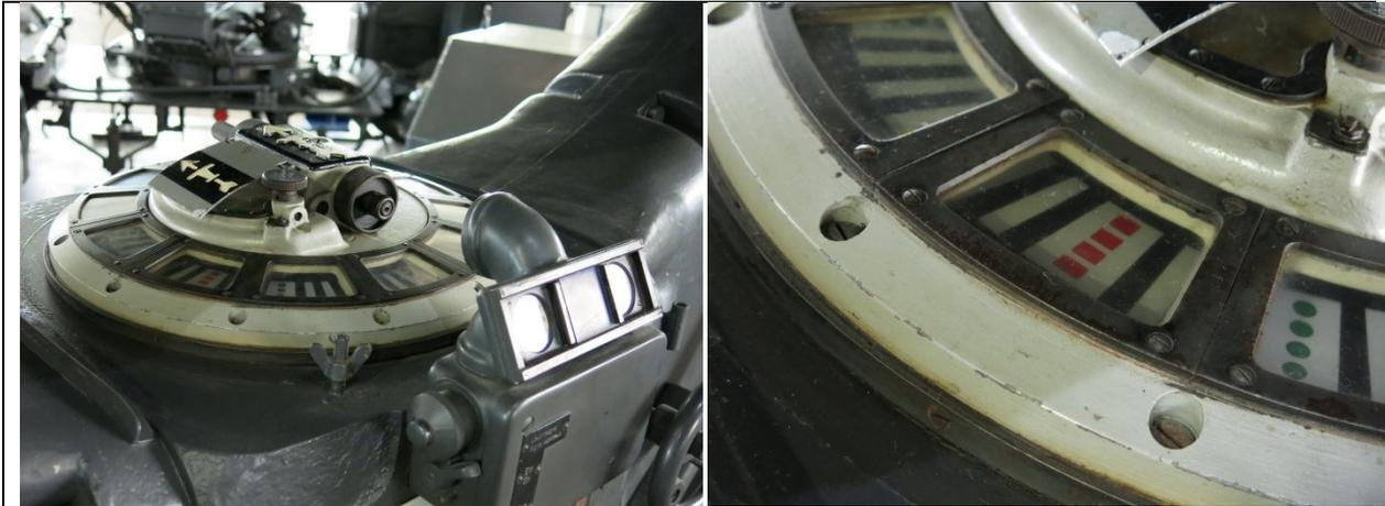
Der Arbeitsplatz der Rechner-Bedienung. Auf der tiefsten Stelle der Tragegabel sitzt die Anzeige mit zwei drehbaren Tellern: oben mit 12 Fensterchen, unten die Scheibe mit Markierungen. Zwei Lichtsignale mit abdeckbaren Schiebern zeigen, wann die beiden Horcher die Position gefunden haben. Rohr: Licht für die Drehscheibe. Rechts unten angeschnitten das Handrad zur Bedienung!
