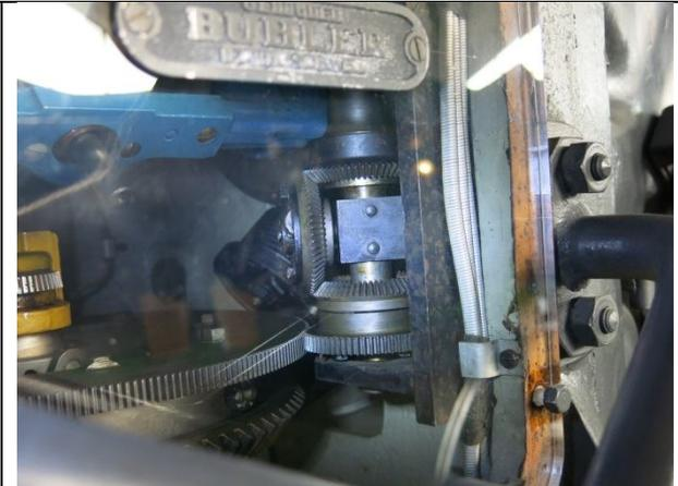
Per Differential wird die Bewegung gegen die Erde plus diejenige des Handrades addiert und oben in den Rechner eingeführt. Kabel rechts für die Lichtsignale, der Rechner ist rein mechanisch.
