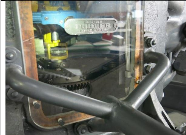
Beim Sitz des 3. Mannes gewährt ein kleines Fenster Einblick zum Rechner Orthognom II. Licht ab Taschenlampe. Das grobe Kegelrad und das feinere Zahnrad darüber stehen fest auf dem Erdboden.
