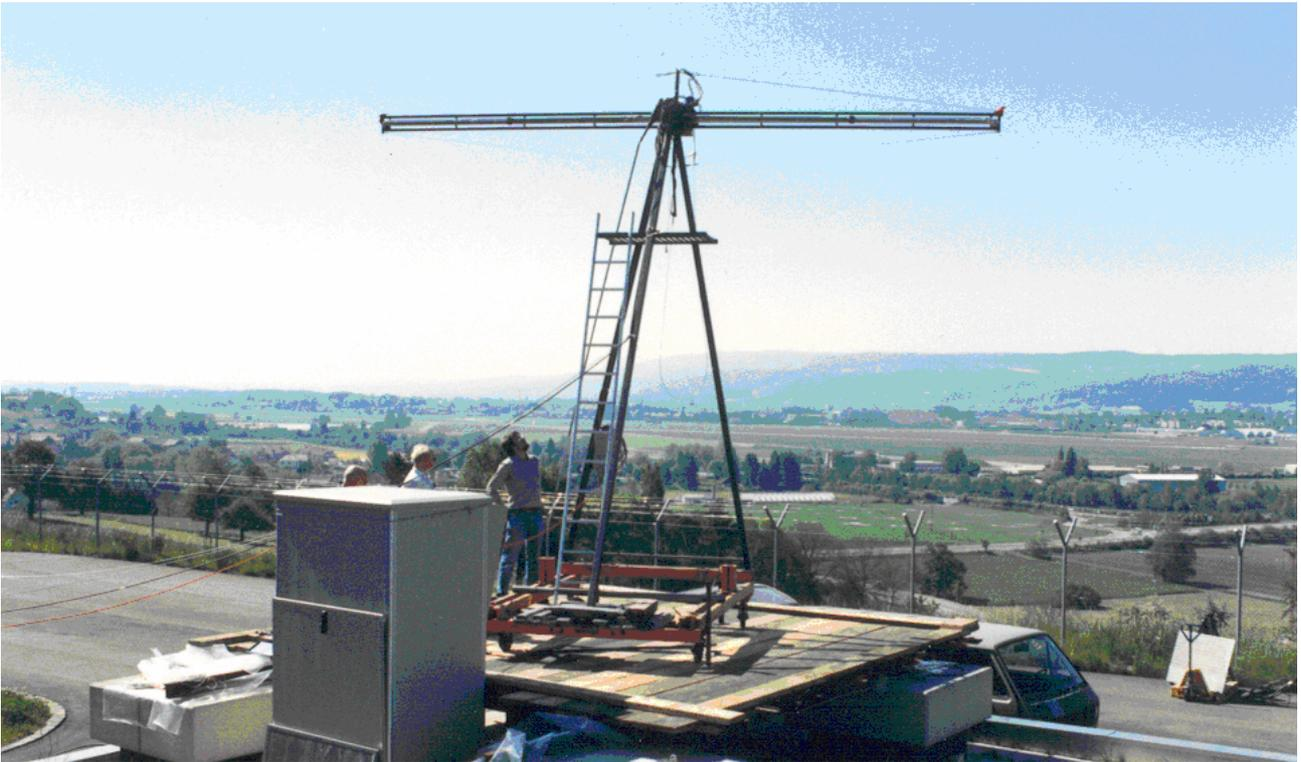
Aus der Figur ist das „Beam – Splitting“ für die Höhenberechnung der Radarziele ersichtlich. Das TAFLIR Radar berechnet die Höhe der Ziele aus einem Amplitudenvergleich der Echos auf zwei benachbarten Empfangsbeam. Für die Höhenberechnung muss die genaue Lage, Stärke und Form der Empfangsbeam – Paare unter Einbezug der LNA's und Receivers bekannt sein. Die Vermessung dieser sog. Antennen - Adaptationsdaten erfolgt für jede ULSA individuell auf dem Antennen Testrange.
