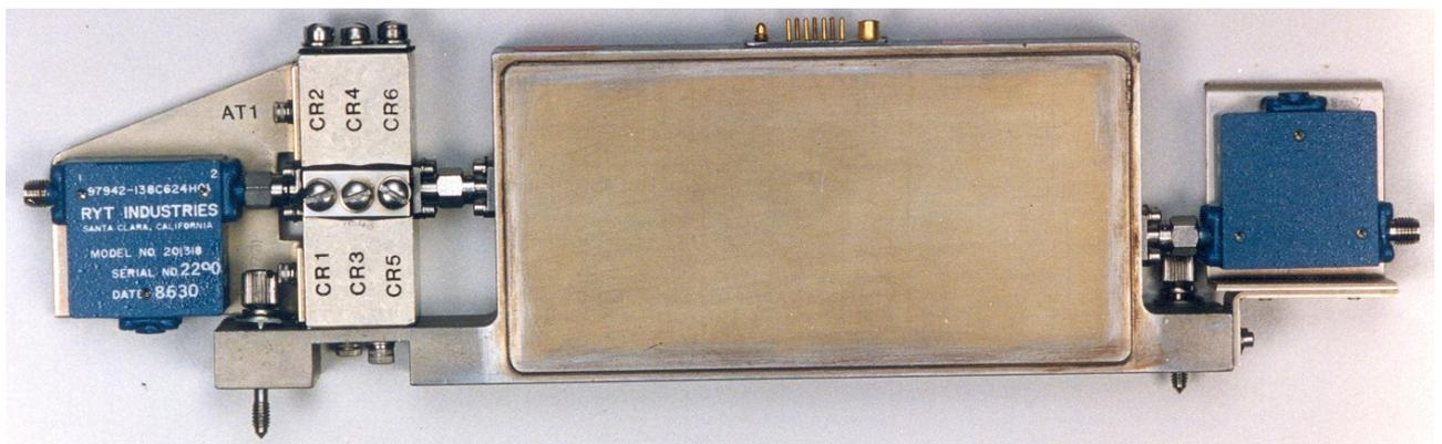
Zur Bildung des „stacked beam pattern“ sind konstante Verstärkungs- und Phasenverhältnisse Voraussetzung. Auch an die koaxialen Verbindungskabel und Stecker zwischen den Strahlerelementen der ULSA und den verschiedenen Matrizen - Netzwerken werden daher sehr hohe Stabilitätsanforderung gestellt.
