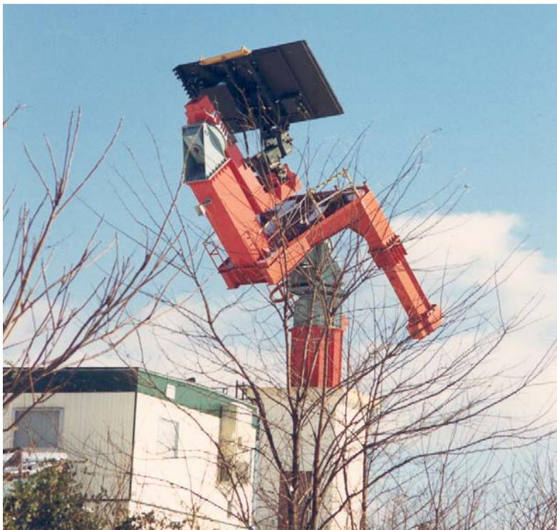
Zum Vermessen der Homogenität des Feldes wird ein Scanner (siehe Foto) verwendet mit dem der Raum sowohl in der horizontalen (siehe Bild) wie auch in der vertikalen Ebene mit einer Empfangsantenne abgetastet wird.
