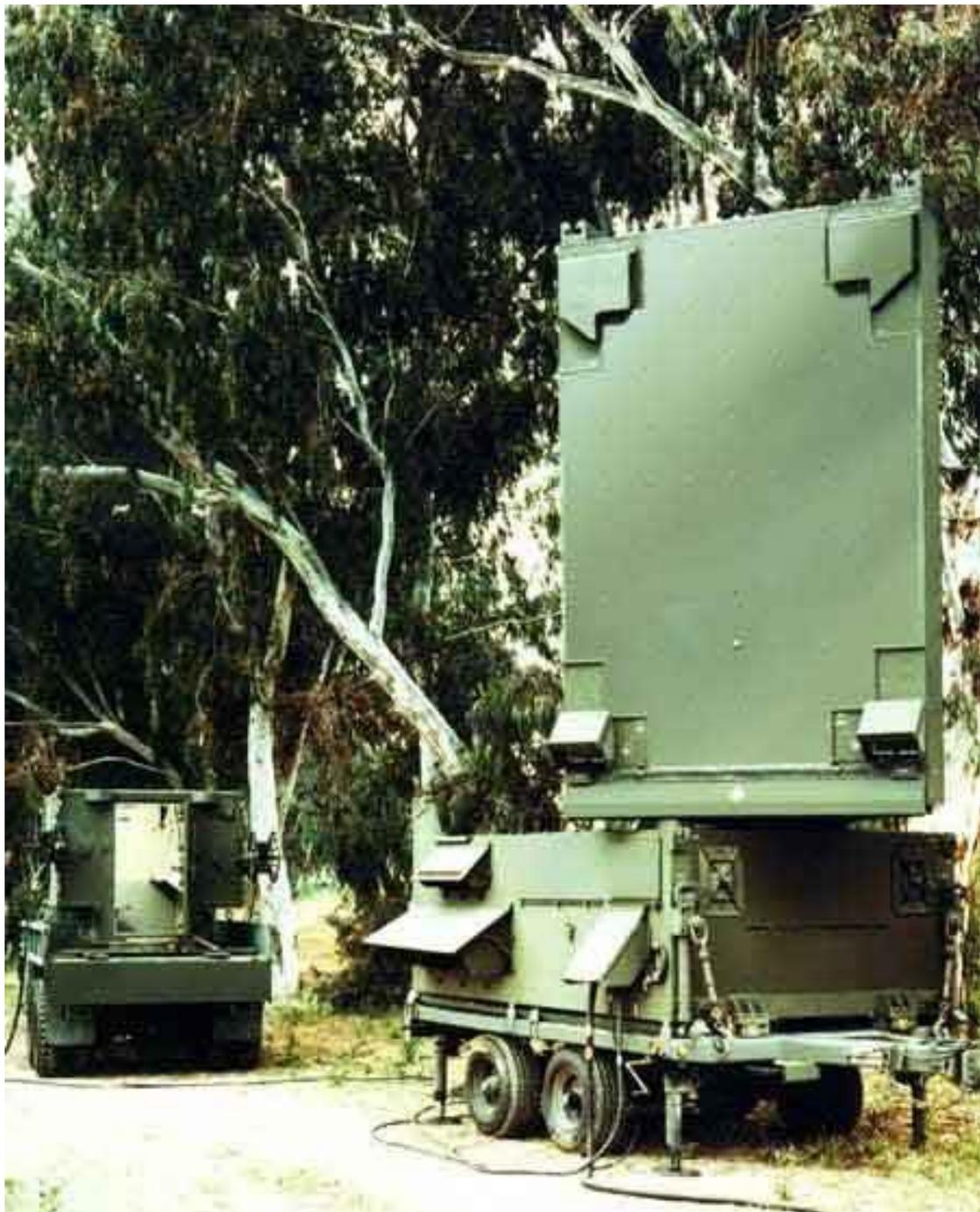
Das AN/TPQ-37 Radar arbeitete im S – Band mit einer instrumentierten Reichweite von 115 km. Die Impulsleistung des Radarsenders betrug ca. 130 kW bei einer mittleren Leistung von 2 kW. Das Sendesystem arbeitete mit einer TWT- Verstärkerkette nach dem Masteroscillator/Poweramplifier Prinzip und konnte innerhalb einer Bandbreite von 10% auf 32 Frequenzen abgestimmt werden.
