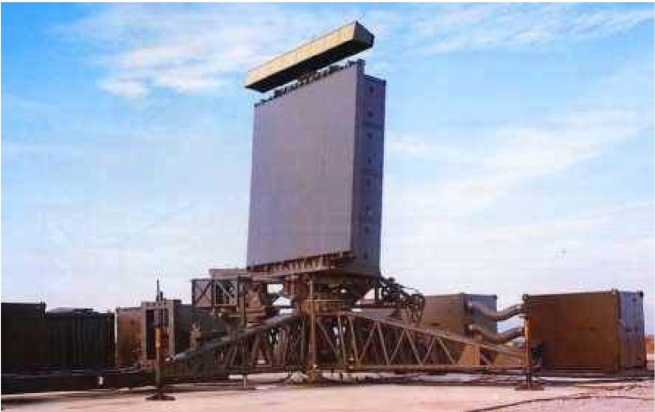
Das RAT-31S Radar arbeitete im S - Band mit einer instrumentierten Reichweite von 330 km. Das Sendesystem lieferte eine Impulsleistung von 135 kW bei einer PRF von 450 Hz, die mittlere Sendeleistung betrug ca. 4 kW.
