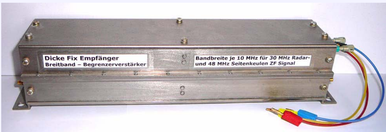
Das Foto zeigt den Schmalband - Verstärker des FLORIDA Dicke Fix Empfängers
