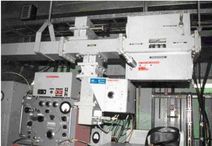
Die Foto zeigt den Messplatz der zur periodischen Kontrolle der Empfindlichkeit des Radarempfängers und der Leistung des AN/FPS20 Anlage diente. Ein Abfall von 1 dB im Sender oder im Empfänger verursacht ein Verlust von 6% an Radarreichweite.
