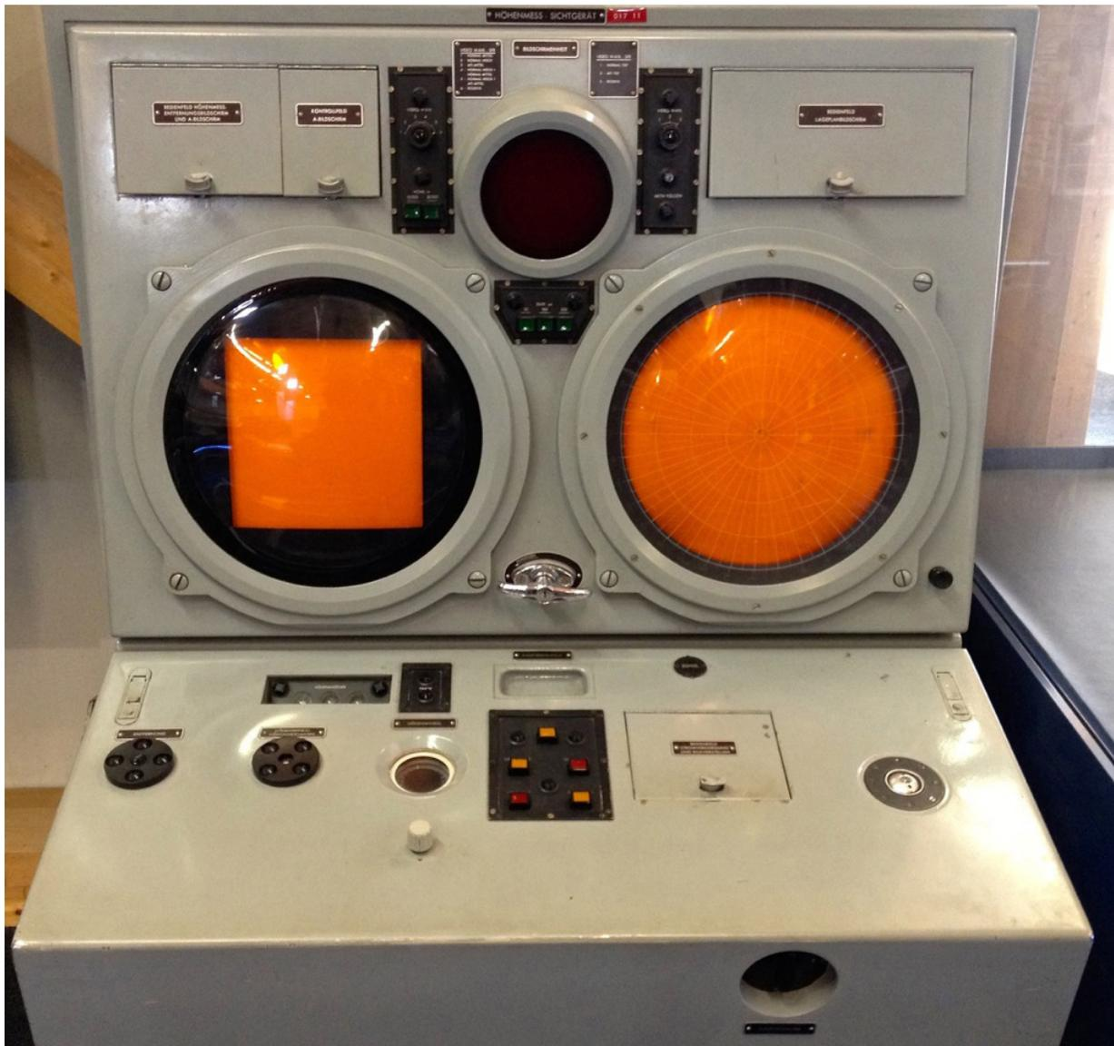
Der links auf dem Anzeigergerät angeordnete Höhenmesser - Bildschirm mit dem quadratischen Ausschnitt zeigt wahlweise einen Höhenbereich von 0 – 15'000 oder 0 - 30'000 Meter in RHI Darstellung.
