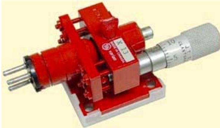
Die unter der Bezeichnung X-13 figurierende Prototyp - Röhre wies gegenüber ihren Vorgängern aus der Zeit des zweiten Weltkrieges eine wesentlich erhöhte Leistung und eine verbesserte Linearität des elektronischen Abstimmbereiches auf und ermöglichte dadurch eine einwandfrei arbeitende Mischung und eine hervorragende automatische Frequenzstabilisierung.
