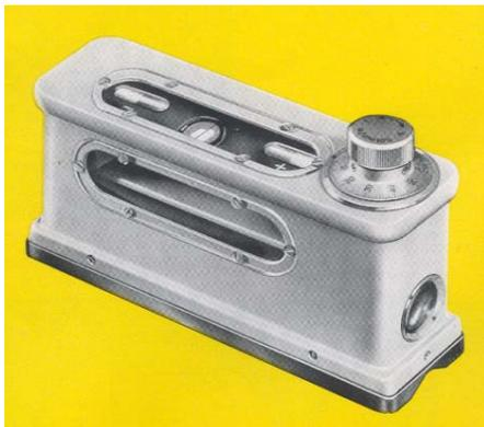
Im weiteren bedingten die neuen Technologien die Beschaffung einer Reihe neuartiger Unterhaltsausrüstungen. So mussten z B wegen den hohen Anforderungen an die Genauigkeit der Höhenvermessung, sehr genaue Wasserwaagen für die horizontale Ausrichtung der Antennen, beschafft werden. Siehe in nebenstehender Figur eine sog. Koinzidenzlibelle der Jenaer Firma VEB Zeiss welche eine Neigungsmessung mit einer Genauigkeit von ca. 2 Winkelsekunden ermöglichte.
