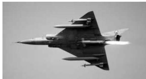
Dassaut Mirage III S mit SEPR 844
