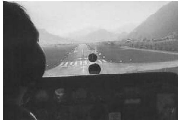
Pistenbefeuerung, man sieht nur die Lampen links und rechts der Piste
