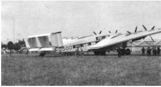
Junkers G-38, 4-motorig, Spannweite 44m, 34 PAX
