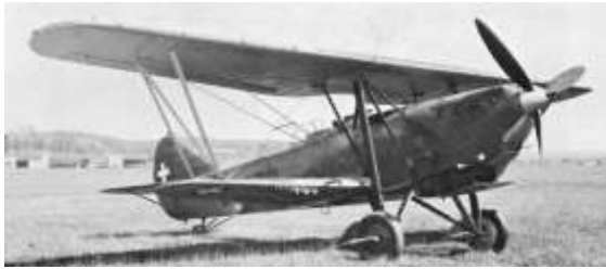
C-35, Hispano-Suiza HS-77 860 PS, 335 km/h, Steigleistung 11.5 m/s
