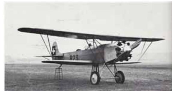
1927: Fokker CV-D mit Jupiter-Sternmotor (420 PS). Das Flugzeug hatte kleinere Tragflächen als der Typ CV-E (nachfolgend).
