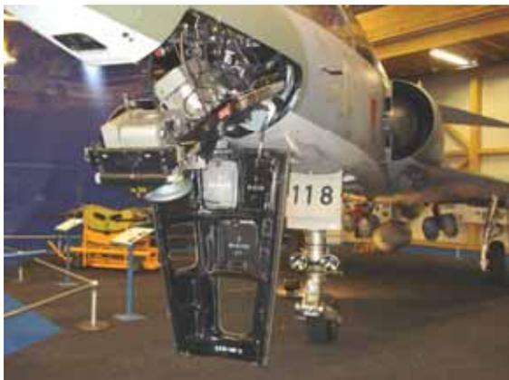
Die Kamera-Anlage abgeklappt
