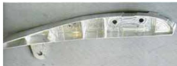
Flügelprofil aus einem Block gefräst.
