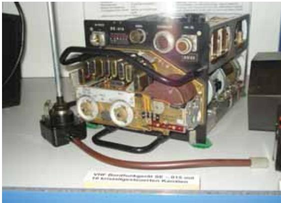
Das Funkgerät SE 012 ging aus dem STR 9 hervor (4 vorabgestimmte Kanäle).
