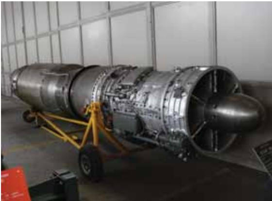
Triebwerk „ATAR“ 09 C-3: Standschub: 4300 kg, mit Nachbrenner 6000 kg, Einwellen-Einstromtriebwerk.
