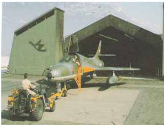
Flz Hunter wird in die Bremszelle geschoben.
