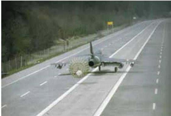
Flz „Hunter“ bei der Landung mit einem Bremsschirm bei der Landung auf einer Autobahn.
