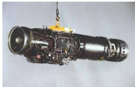
J-85-GE-21: 1588 kg Schub ohne Nachbrenner; 2268 kg Schub mit Nachbrenner („Tiger“ II F-5E und F). Einwellen-Einstromtriebwerk.
