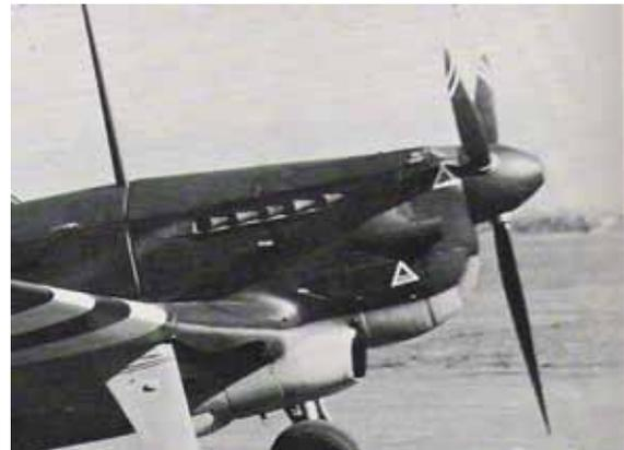
D-3800/01 und C-3603: Escher-Wyss. Constant-speed, Metall (wurde hydraulisch verstellt)
