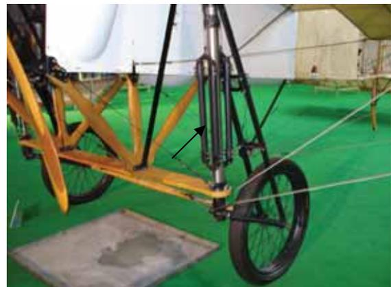
Abfederung beim Flz „Blériot“. Je Fahrwerkseite 4 Gummistrippen
