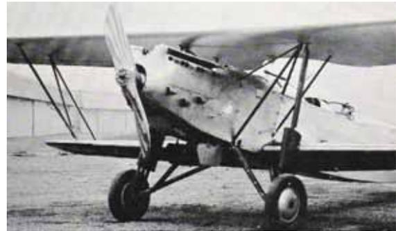
CV: Befestigung mit verschraubter Nabe
