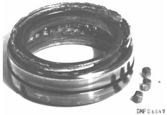
„Ghost“: Kugellager zu Rotorwelle defekt.
