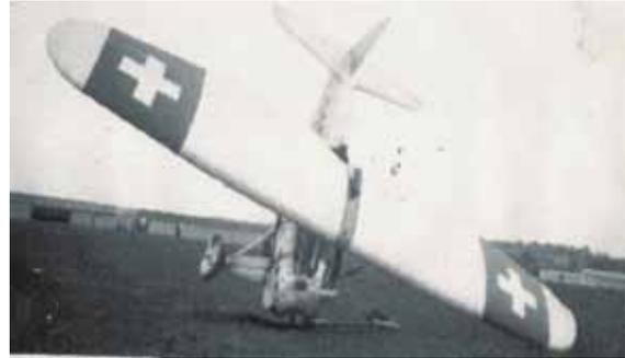
Kopfstand eines FlzD-27: Immer auch der Propeller.
