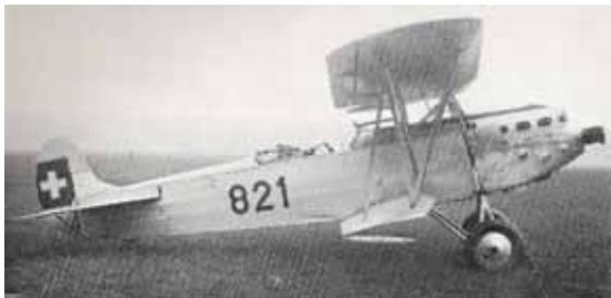
1933: Fokker CV-E . Es wurden 49 Flz abgeliefert. Doflug fertigte die Rümpfe und die Firma Comte baute die Flügel.
