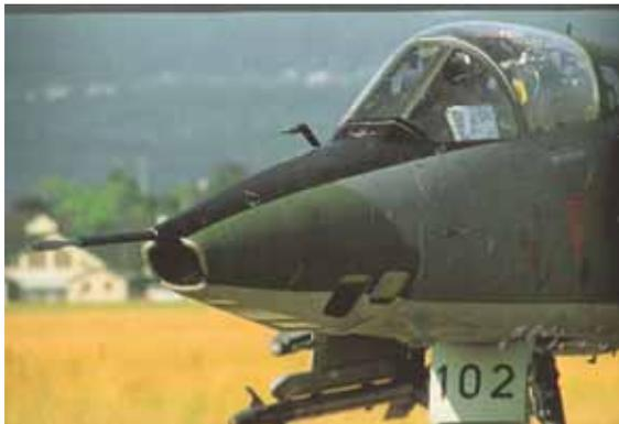
„Mirage“ III RS: Die Öffnungen für die Kameras sind sichtbar (vorn, seitlich und unten).
