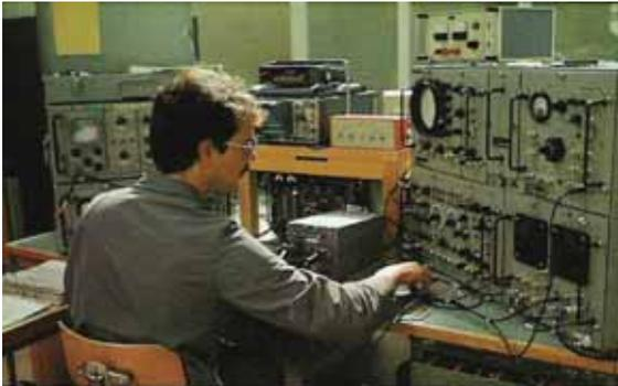
Prüfstation für IFF- Gerät
