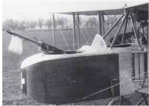
DH-1: Der Beobachter hatte vorne im Bug ein Maschinengewehr auf einer Drehlafette montiert. Der Sack vorne am MG fängt die Hülsen auf, sonst würden sie in den hinten drehenden Propeller gelangen und diesen beschädigen.
