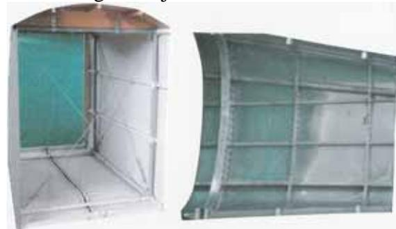
Drahtverspanntes Stahlrohrgitter mit Stoffbespannung
