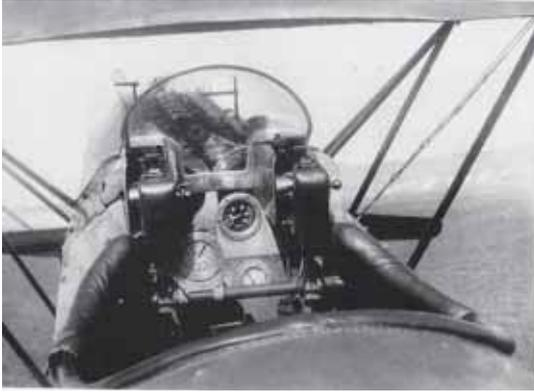
Synchronisiertes Maschinengewehr über dem Motor, durch den Propellerkreis schiessend.
