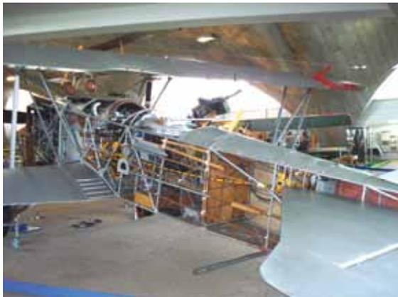
Fokker CV, drahtverspannter Stahlrohrumpf mit Stoff überzogen
