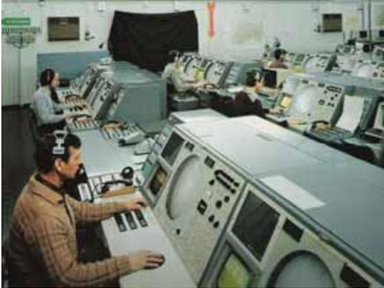
Blick in eine Einsatz-Zentrale, in welcher die gesamte Luftlage über der Schweiz und im benachbarten Ausland dargestellt und überblickt werden kann. Von hier aus werden alle in der Luft befindlichen Flugzeuge bis zum Erfassungsbereich der GCA (Landeradaranlagen) geführt.
