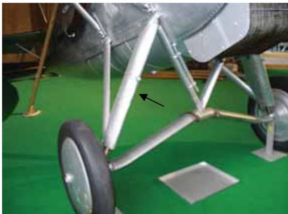
D-27. Festes Fahrwerk mit integriertem Stossdämpfer Mésurier
