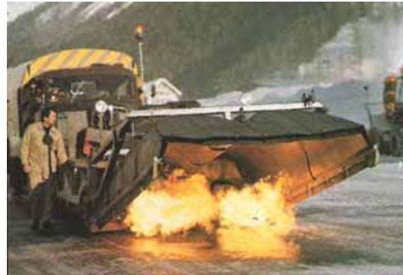
Ein anderes Modell eines Enteisungsfahrzeugs. Das geschmolzene Wasser wird hinter dem Feuer abgesaugt.
