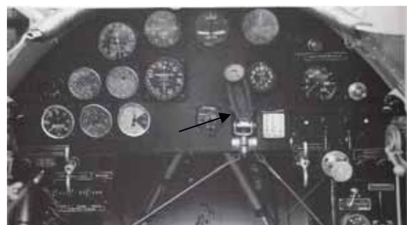
CV und C-35: Betätigung der Bremse mittelst einem Hebel im Pilotenraum über ein Drahtseil.
