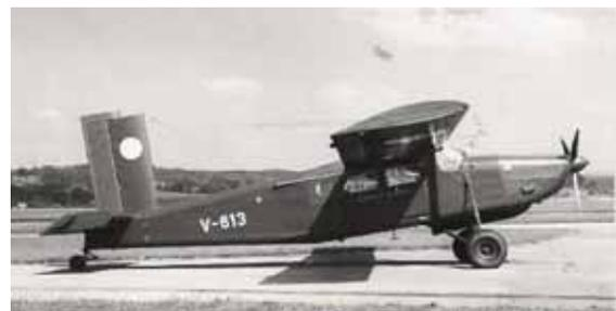
1967: Pilatus-Porter PC-6/H2M. Es wurden 12 Flz beschafft. Das Flz war mit einem Kolbenmotor ausgerüstet und diente für Transporte sowie für die Ausbildung der Fallschirm-Grenadiere
