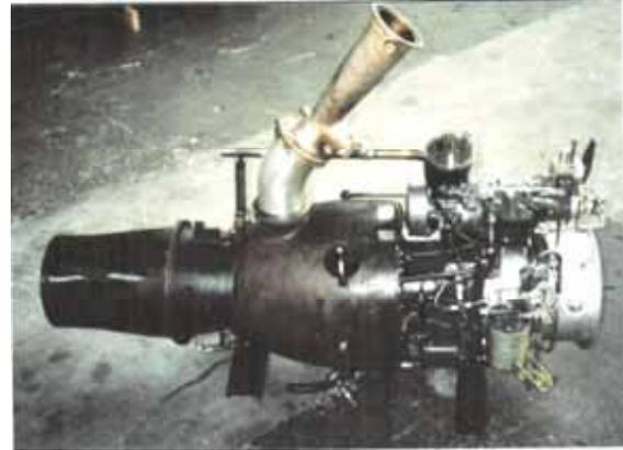
„Palouste“ IV: 240 PS. SO.1221 S („Djinn“). Der Stutzen für die abgezapfte, verdichtete Luft zu den Rotorblättern führt vom Kompressor nach oben.
