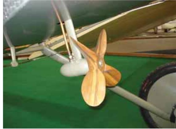
DH-1: Luftgetriebene Benzinpumpe.
