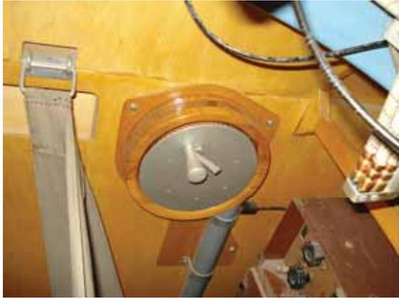
FG I: Aufspulvorrichtung für das Antennenkabel
