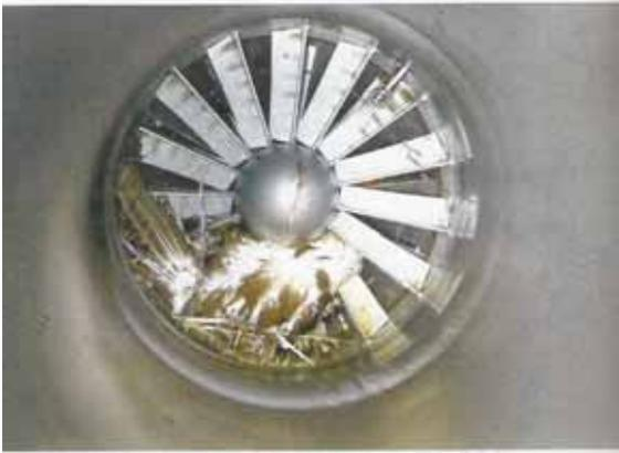
Vögel wurden vom Kompressor angesaugt und beschädigten die Kompressorschaukeln.
