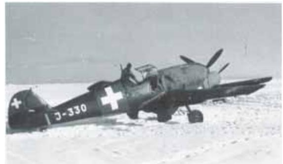
Warmhalten eines Flz Me-109E mit Wärmedecken und im Sack (unter dem Rumpf) Katalyten.
