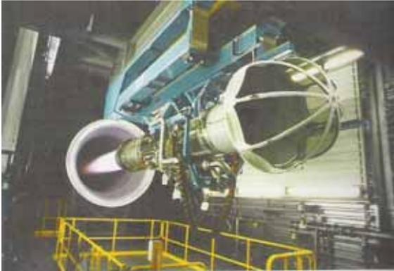
Triebwerk F-404 des Flz F/A 18 auf dem Prüfstand
