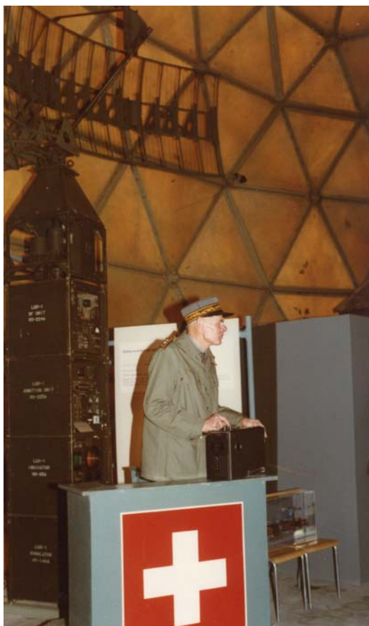
Im Radome-Museum: Radargerät AN/TPS-1A, SFR-Antenne
