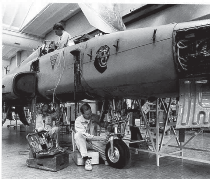
Unterhaltsarbeiten am Tiger / Entretien sur Tiger / Manutenzione al Tiger
