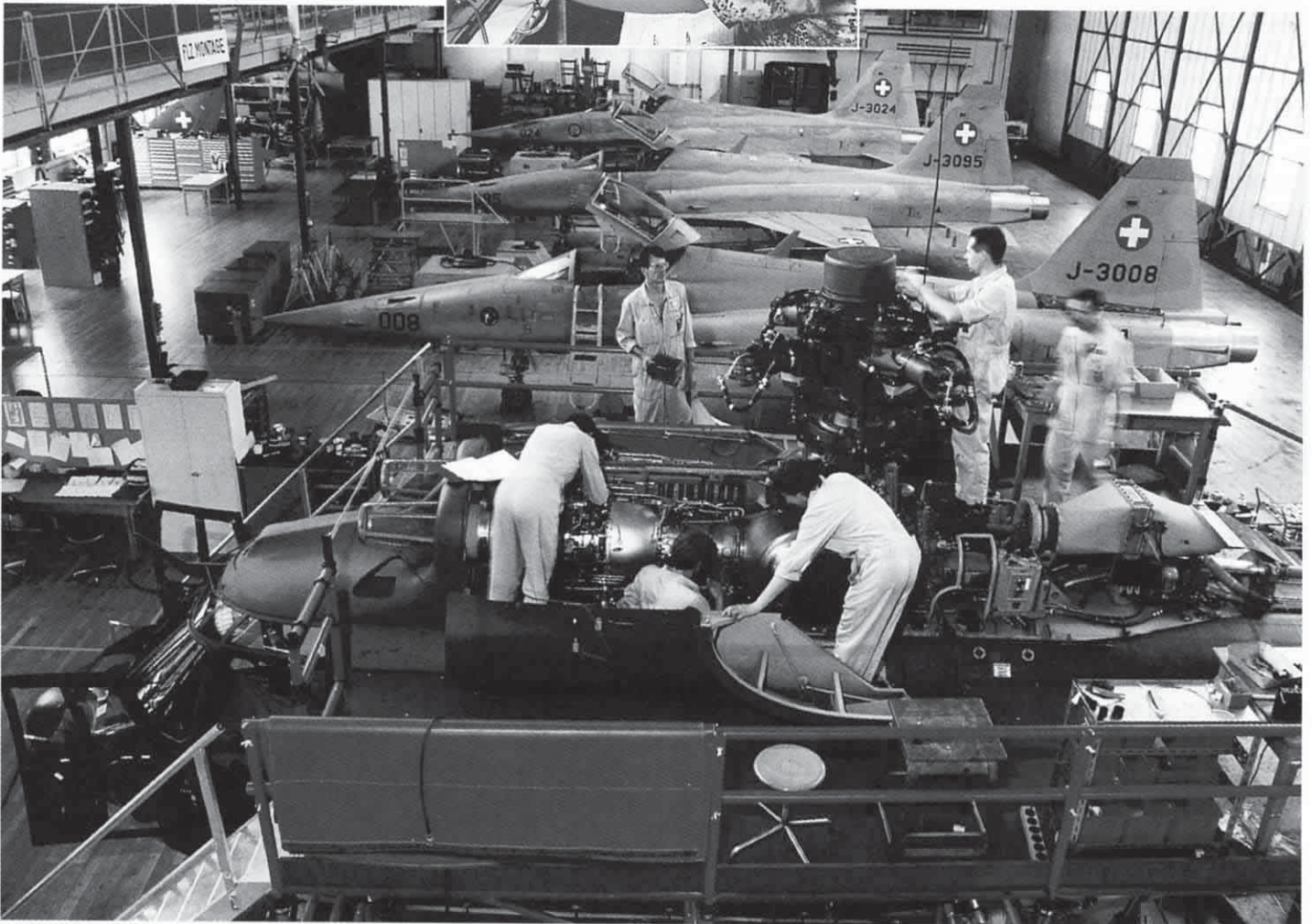
Flugzeug-Montage mit SUPER PUMA und F-5 Tiger / Assemblage des avions / Assemblaggio aerei
