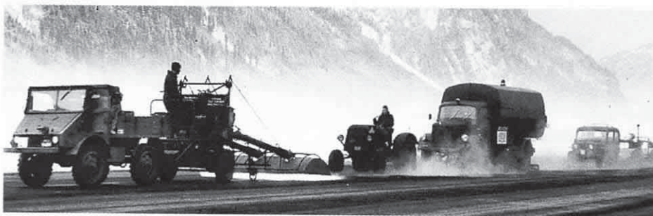
Enteisungsmaschine «Woolery» Dégivrage de la piste (machine Woolery) Sgambero neve della pista (macchina «Woolery»)
