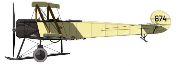
Das erste Exemplar der 504 startete, angetrieben von einem Gnôme-Lambda-Umlaufmotor mit 59 kW (80 PS), im Juli 1913 in Brooklands zu seinem Erstflug. Mit einem Passagier an Bord erreichte die Maschine eine Flughöhe von 5 000m, ein Rekord zu damaliger Zeit.
