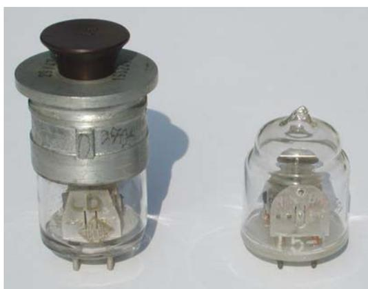
Wegen Beschaffungsproblemen gegen Ende des Krieges versuchte Brown Boveri die Telefunken Röhre LD1 (Röhre links im Bild) unter den Bezeichnungen T5 und T3 nachzubauen (Röhre rechts im Bild). Als dies nicht gelang wurden die TLD Sender mit der Original Telefunken Röhre LD1 bestückt. Die KTA beschaffte dafür nach Ende des Krieges eine grössere Anzahl dieser Röhren aus deutschen Restbeständen bei der STEG-Behörde.
