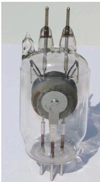
Die Arbeiten von Dr. Fritz Lüdi mit Mikrowellenoszillatoren, zunächst an der ETH und später bei BBC, wurden bereits erwähnt. Dr. Lüdi konstruierte unter anderem den sogenannten Turbator (siehe nebenstehendes Bild), ein Einresonator-Magnetron, dessen spektrale Reinheit die grundsätzliche Verwendbarkeit für Richtstrahlsender möglich machte.
