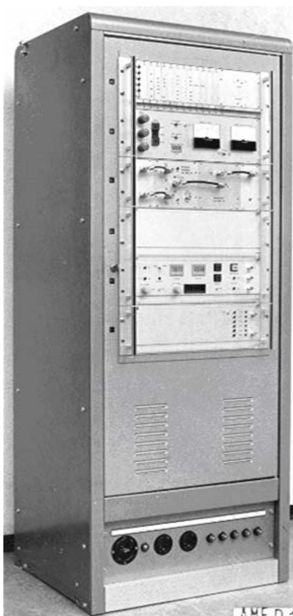
Die breitbandige Uebertragung erfolgte über die inzwischen nicht mehr verwendeten IM 23 Richtstrahlsstrecken. Die sowohl richtungs- wie entfernungsmässig korrelierenden Primär- und Sekundärvideos wurden gemischt und auf einem gemeinsamen Breitbandkanal übertragen.
