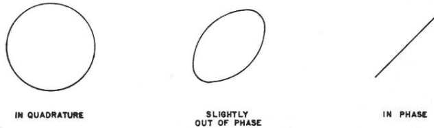
Lissajou Figuren für ein 1 : 1 Frequenzverhältnis bei verschiedenen Phasenlagen der zu vergleichenden Frequenzen.
